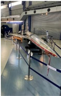
次世代の超音速旅客機実現に必要な空気抵抗が小さい形状を設計（胴体のくびれ、矢じり型の翼、翼のねじり等）
