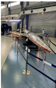
次世代の超音速旅客機実現に必要な空気抵抗が小さい形状を設計（胴体のくびれ、矢じり型の翼、翼のねじり等）し、2005年に飛行実証を行った。それまでの長音速旅客機と比較し、約13%の空気抵抗低減に成功した。
